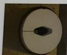
**2.** Permur Monolith-Spezialschalung incl. montiertem Montagedeckel mit der Trennleiste nach unten auf den bereits vormontierten Montagedeckel aufstecken. Styropordeckel ca. 1 cm überstehen lassen; wird beim Schließen der Schalungsplan gedrückt. Eine weitere Befestigung ist nicht nötig und die Schalung kann geschlossen werden.
